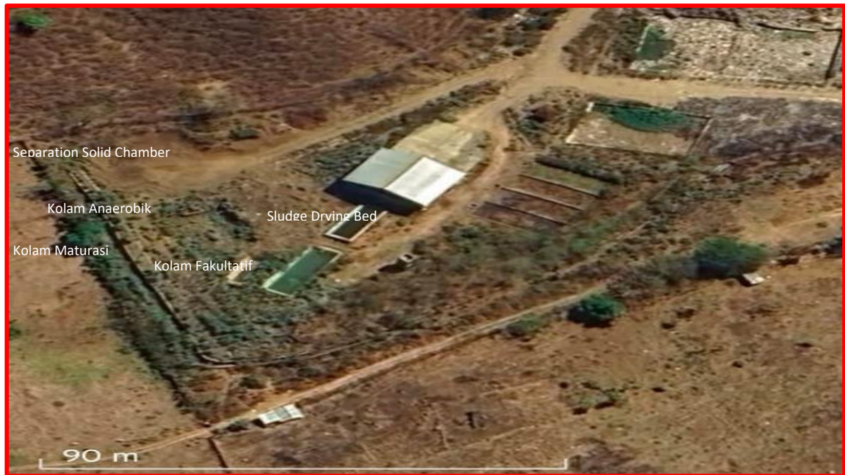
Gambar 7. Unit Stabilisasi Air Limbah Domestik IPLT Batu Putih
