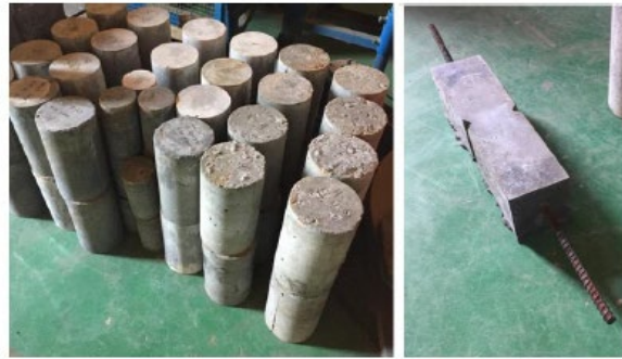
Gambar 12 Benda uji Silinder dan balok UHPC
